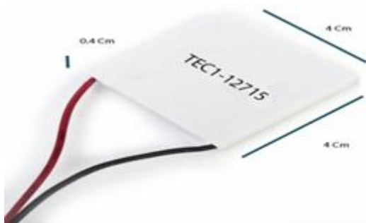
Hình 5: Sử dụng Sò nóng lạnh ứng dụng trong nguồn thải nhiệt xanh
