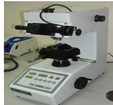
Hình3. Máy đo độ cứng tế vi dưới tải trọng nhỏ
