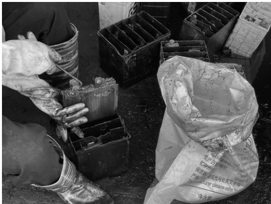
Hình 2. Phá dỡ ắc quy theo phương pháp thủ công tại Đông Mai
